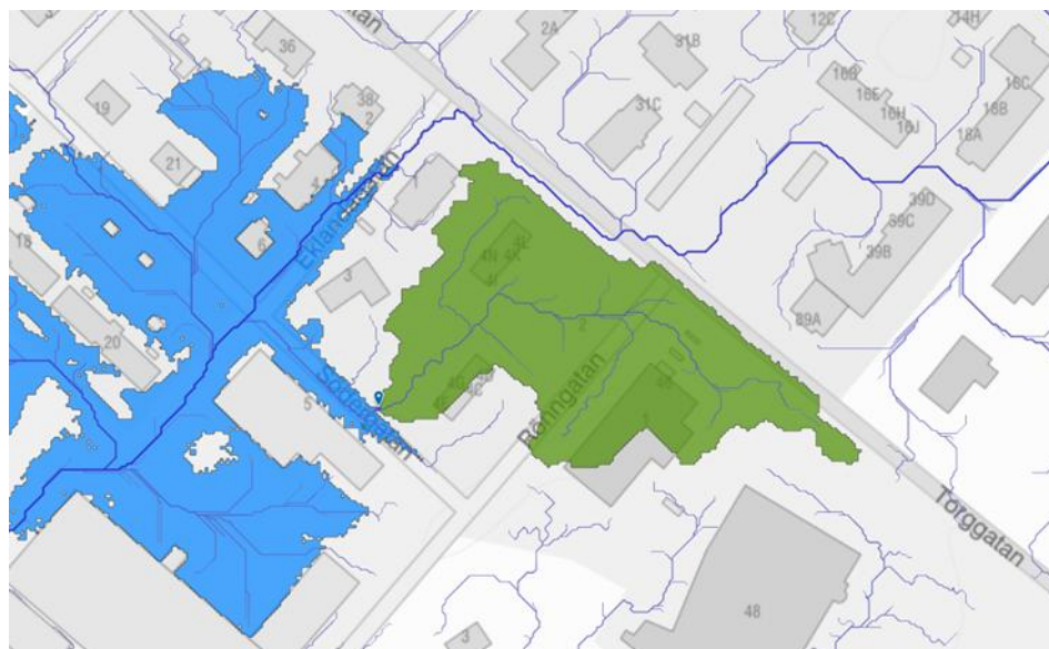
Figur 3 Bilden ovan är ett skärmdokument från Scalgo som redovisas i tillhörande dagvattenanalys som redovisar ytliga avrinningsvägar med de blå linjerna. Det grönmärkade området, som berör planområdet, utgör ett delavrinningsområde till det blå markerade området.
